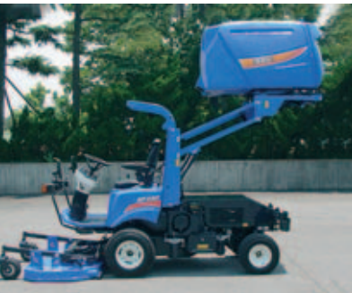
2 Větší zásobník na trávu. Vyklopění do výšky 210 cm s přesahem 38 cm.
