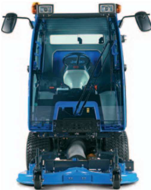
3 Ventilátor chladiče garantuje teplotní stabilitu v každé situaci. Automatický ventilátor chlazení umožňuje obsluhu se plně věnovat pracovní činnosti. Systém stroje se během provozu pohybuje v přípustných pracovních teplotách.
