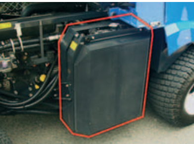
3 Ventilátor chladiče garantuje teplotní stabilitu v každé situaci. Automatický ventilátor chlazení umožňuje obsluhu se plně věnovat pracovní činnosti. Systém stroje se během provozu pohybuje v přípustných pracovních teplotách.
