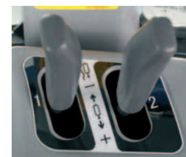
9. Ovládání zadní hydrauliky Pro čtyři sériové hydraulické přípojky vzadu. Dvě dvojčinně řídicí jednotky lze přestavit na jednočinné.
