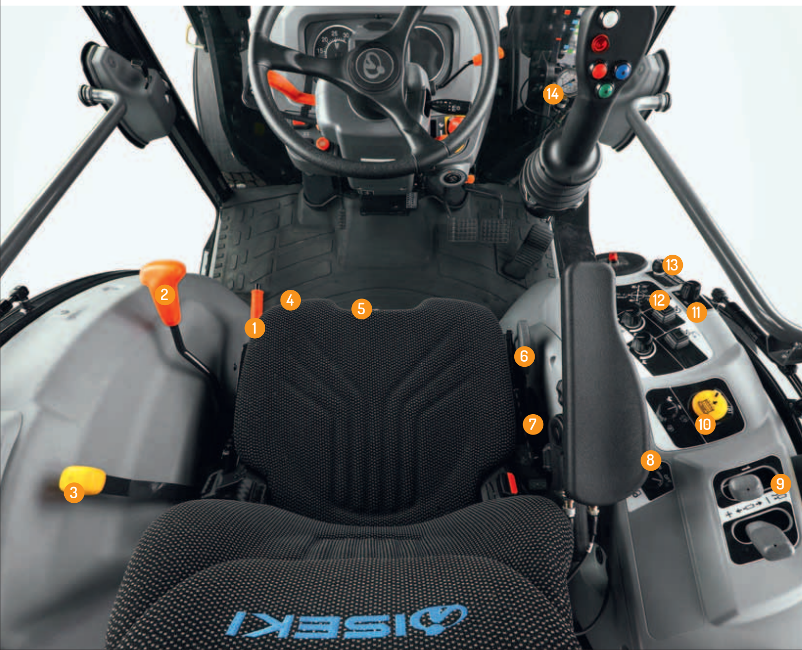
4. Uzávěrka diferenciálu Přímo pod ruční brzdovou pákou najde řidič pedál uzávěrky diferenciálu.
