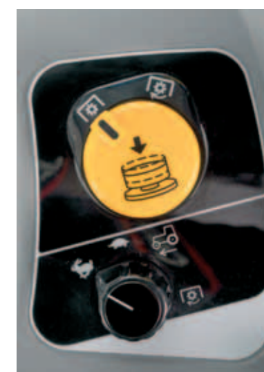
10. Ovládání vývodového hřídele Ovládání vývodového hřídele lze vždy poznat podle žlutého barevného označení. Vývodový hřídel je tedy možné pohodlně aktivovat vyobrazeným vypínačem vpravo vedle sedadla. Další funkcí je automatika Start/Stop vývodového hřídele, kterou lze aktivovat otočným spínačem vpravo vedle sedadla řidiče. Do sériové výbavy patří také hladký rozběh vývodového hřídele.
