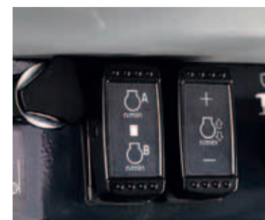
7. Regulace otáček Regulace nabízí řidiči možnost uložit do paměti dvoje otáčky motoru a stisknutím knoflíku je aktivovat. Přitom je možné nastavit a uložit otáčky pomocí dvou vyobrazených spínačů.
