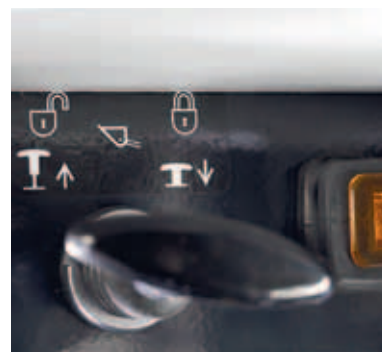
6. Blokování křížové ovládací páky Pouze u hydraulické jednotky BASIS. Ve verzi Profi slouží k ovládání uvolňovací tlačítka na joysticku.
