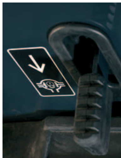
4. Uzávěrka diferenciálu Přímo pod ruční brzdovou pákou najde řidič pedál uzávěrky diferenciálu.
