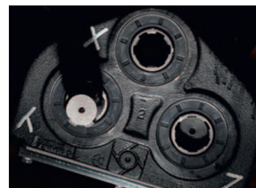
Čelní vývodový hřídel s volitelným reverzním ústrojím; 2000 ot./min. vpravo a 1000 ot./min. vlevo.
